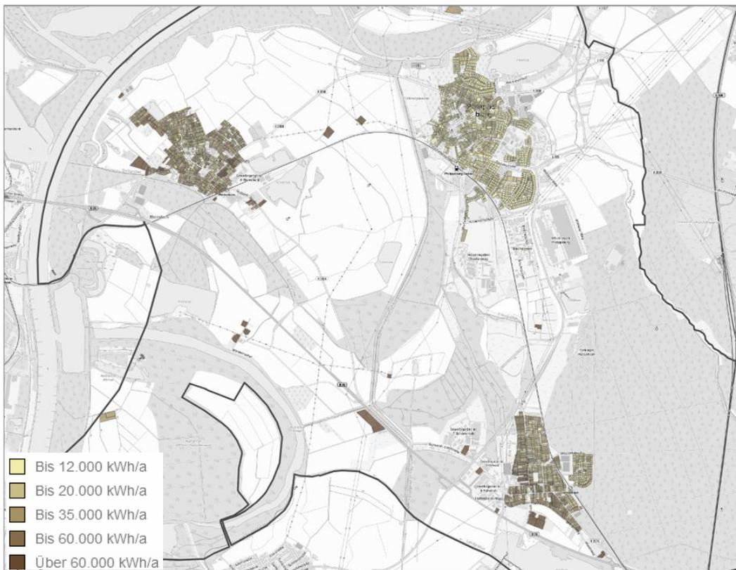
Abbildung 25: Räumliche Verortung des theoretischen Maximalpotenzials zur Nutzung von Erdwärmesonden (KEA-BW, 2022a)
