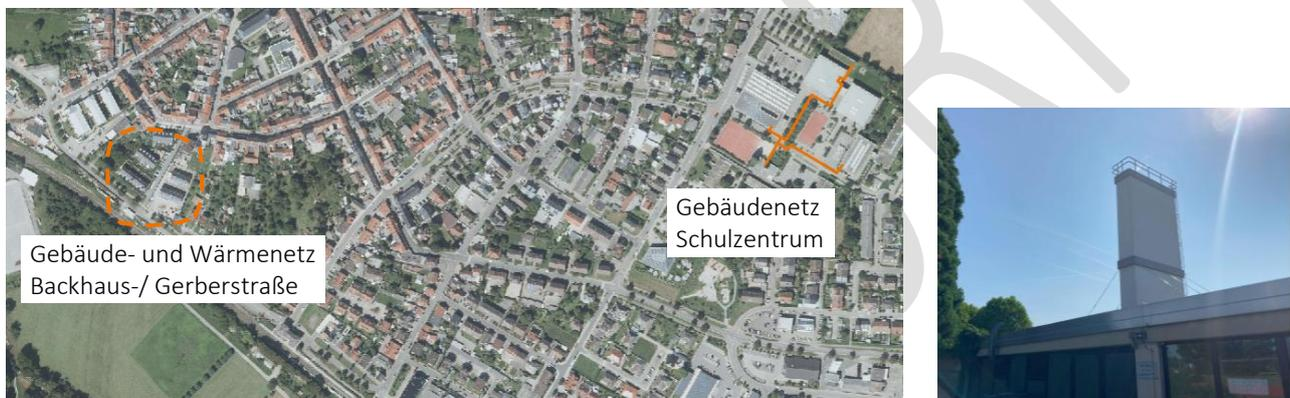
Abbildung 11: Räumliche Verortung bestehender Wärmenetze sowie Heizzentrale am Schulzentrum Philippsburg
